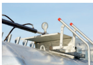
Pumpás tartálykocsinál: hidraulikus tolótető
