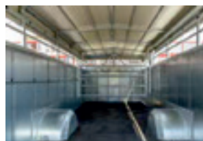
Állítható elválasztó rács és bordás acéllemez borítás kifolyónyílással
