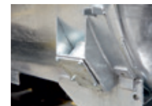
Alapfelszereltségben csatlakozó karimák elől, jobb és bal oldalon, valamint hátul
