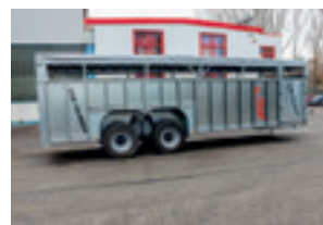
TTW 140 Tandem Noah állatszállító hossza 8,3 m, így kiválóan alkalmas nagyobb állatok szállítására
