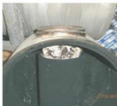
A fehér kristályszerű karbamid lerakódások eldugítják a kipufogót
